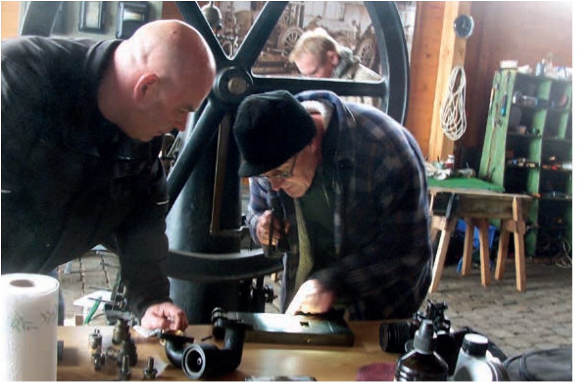
Zunächst wurde der Schieber zerlegt, gesäubert und mit dichtendem Öl eingestrichen
