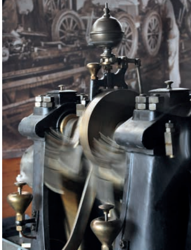
Fliehkraftregler und Pleuel im Einsatz ...
