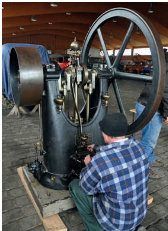
Nach Korrektur der Steuerzeiten ...
