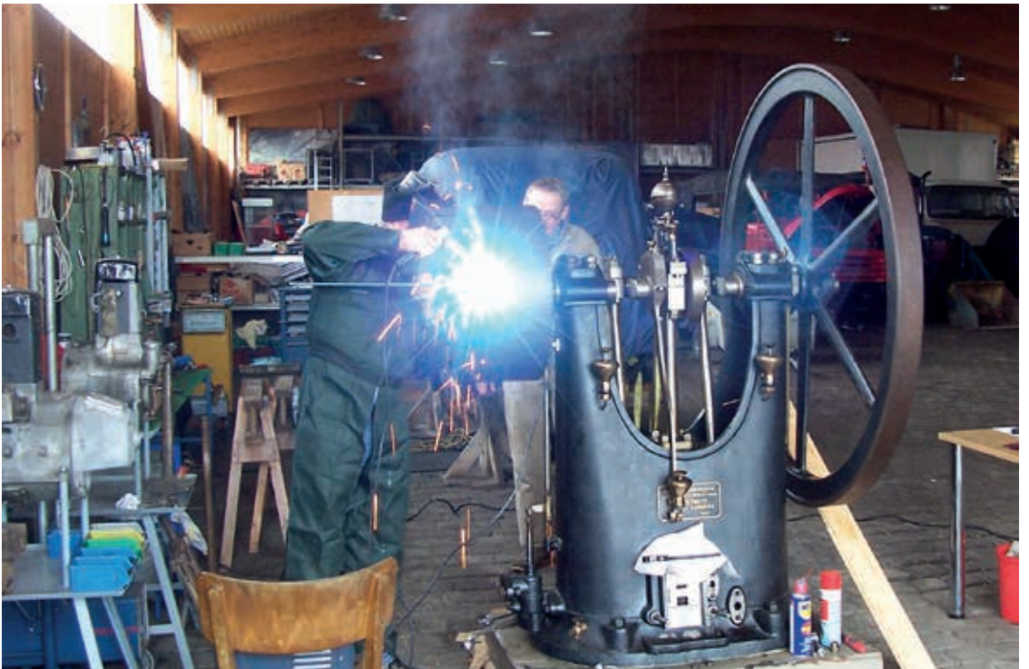
Um die Schwungscheibe demontieren zu können, musste eine Abziehvorrchtung angebracht werden
