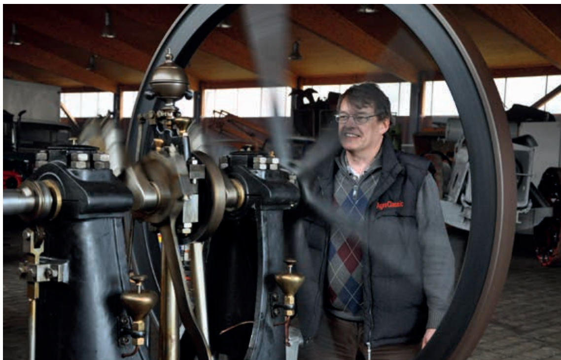
Fliehkraftregler und Pleuel im Einsatz ...
